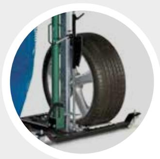
Aucun levage manuel. L'élevateur peut lever la roue directement à partir du niveau du sol.
