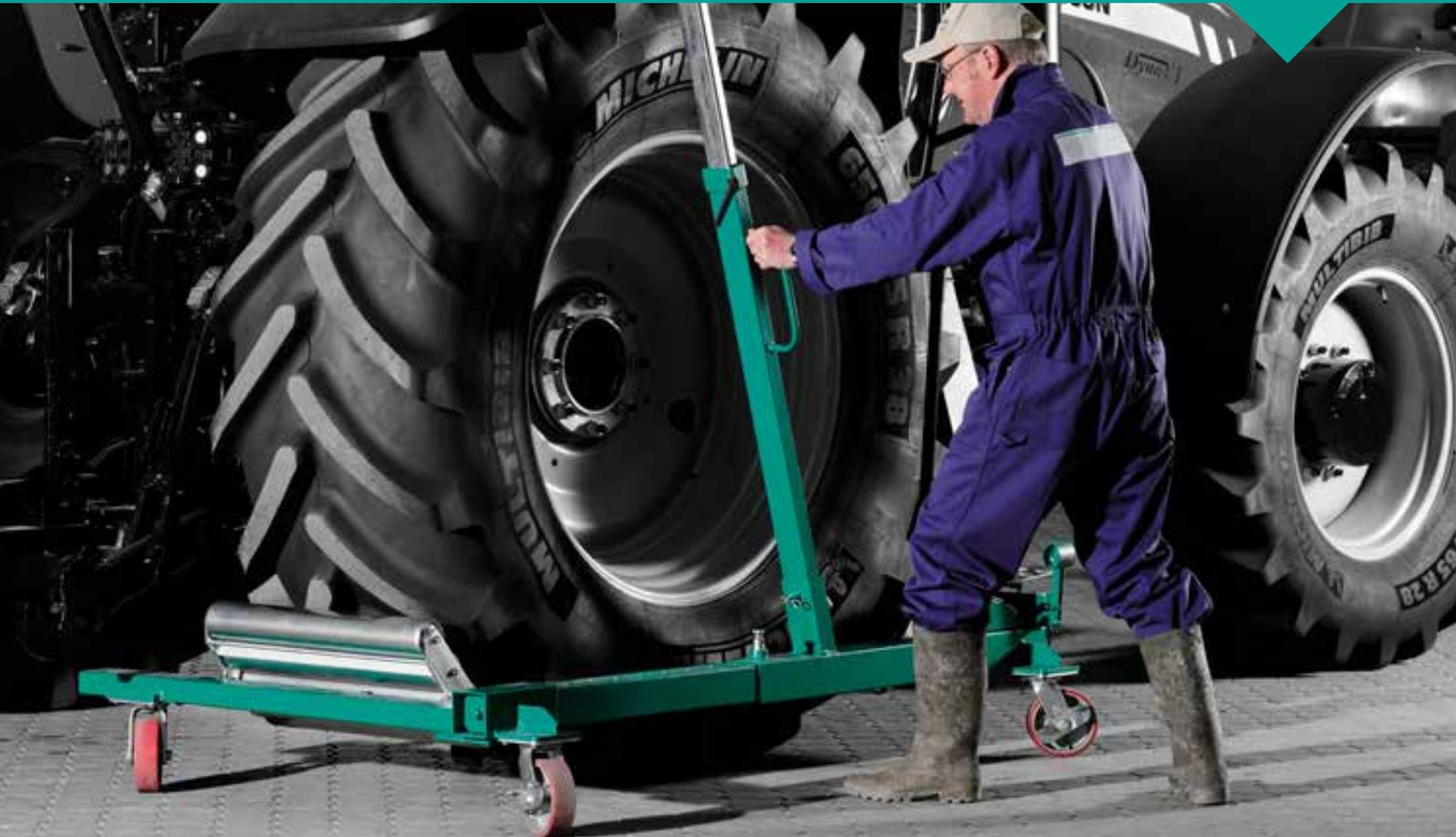
Manipulation facile de roues de grande dimension avec un diamètre compris entre 1250 mm et 2400 mm et de roues de grande largeur jusqu'à 1050 mm.
