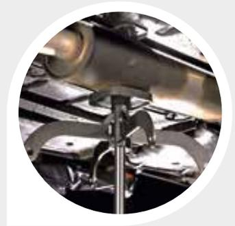
Adaptateur rotatif de boîtes devitesses avec selle et coussin de caoutchouc.
