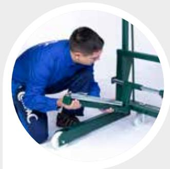
Bras coulissants qui permettent la manutention de roues de diamètres compris entre 260 mm et 1320 mm.
